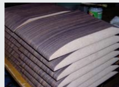
ASW-Grundstoff: solide Faserplatte mit den unterschiedlichsten Furnieren.
