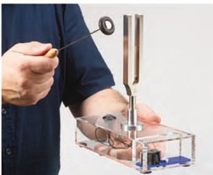
Der Test mit der präparierten Stimmgabel bewies die Wirkung der piezokeramischen Folie
