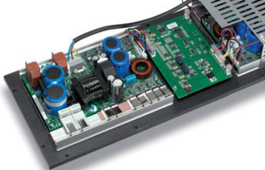
Cool: Trigon-Endstufenschaltungen mit ICE-Power-Chips und mächtig Dampf
