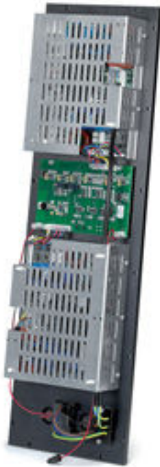
Zwillinge: Zwischen den Class-D-Endstufen sitzen Steuerung und Netzteil
