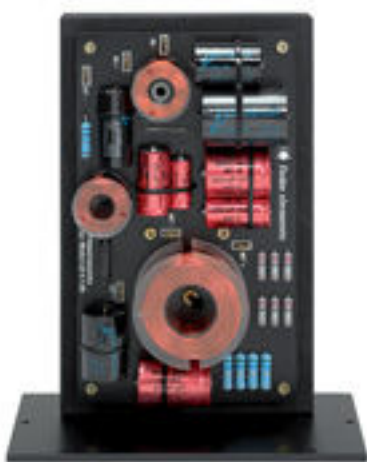
Unsichtbarer Einschub: die passive Frequenzweiche für Mittel- und Hochtöner
